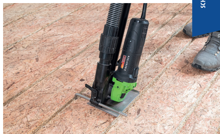
Leichtes Führen durch Parallelanschlag
