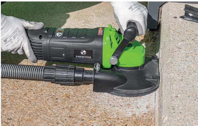
Schleifarbeiten bis unmittelbar an die Kante möglich
