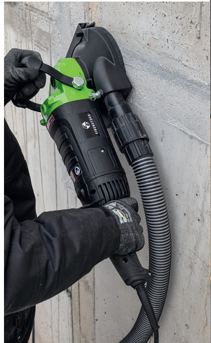
Handgriff 180 Grad drehbar
