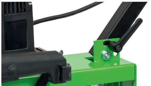
Neigungsverstellung für ergonomisches Arbeiten
