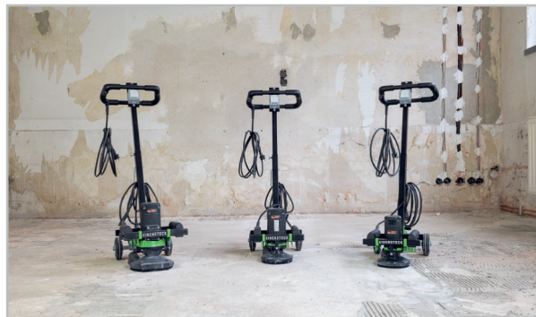
Bodenführungsgestell für EBS 125/ EBS 1802/ EBS 180 H
