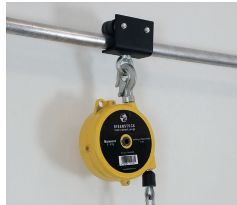
Leichtlauf der Balancer-Aufhängung
