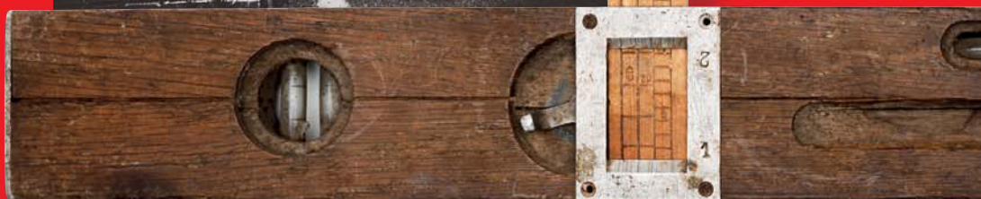
1949 — vodováha se sklonoměrem NT4 ze dřeva
