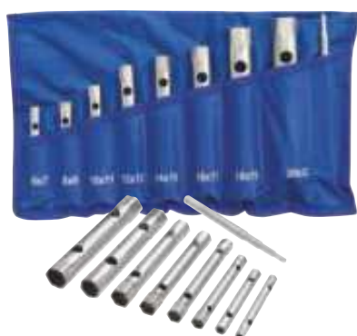
Sada nástrčných klúčov, vyrobené z rúrkovej ocele (C35) kalené pochrómované konce 6-stranné s dutým hriadel'om 8-dielna 6x7, 8x9, 10x11, 12x13, 14x15, 16x17, 18x19, 20x22
